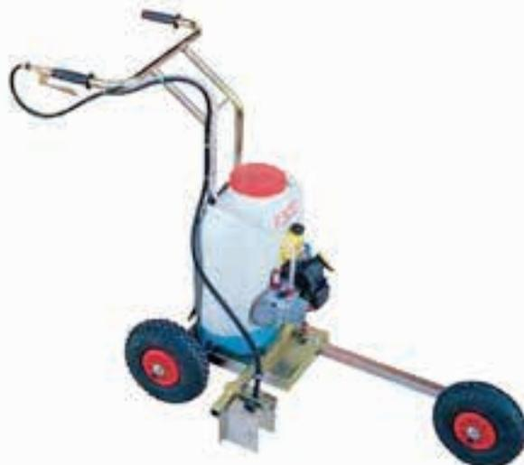
Carrello segnacampo con motore a scoppio, montato su ruote gommiate con camera d'aria, ruote anteriore con snodi regolabile che permette di effettuare la tracciatura delle linee curve, sistema di spruzzatura laterale
