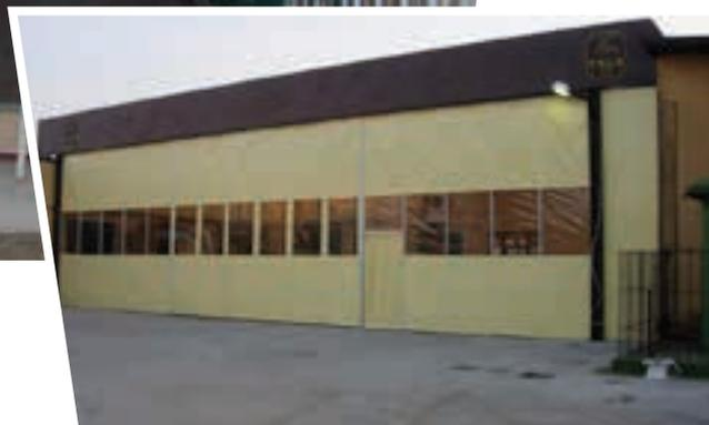
La Parete Mobile è la soluzione più economica e funzionale per dividere 2 zone di lavoro in un capannone, oppure per chiudere una tettoia e trasformarla in questo modo in un comodo garage. La parete si ancora al soffitto tramite una guida in acciaio e scorre lateralmente grazie a carrelli in acciaio fissati alle estremità superiori dei profili. Il sistema di chiavistelli consente di bloccare la parete a terra in modo che non venga fatta ondeggiare dal vento.
